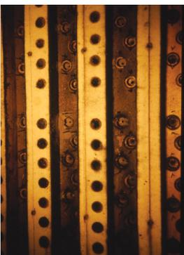
Abb. 10 Oben geöffnete Registerkanzellen einer mechanischen Kegellade: Orgel in Loja (Ecuador) von Wilhelm Sauer, 1892
