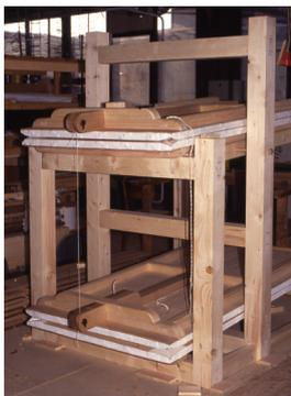
Abb. 5 Balggestell mit zwei übereinanderliegenden, geschlossenen Keilbälgen: Neu-Bamberg (s. Abb. 4)
