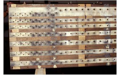
Abb. 7 Schleiflade mit abgenommenen Pfeifenstöcken: Hillscheid (Westerwald, Rheinland-Pfalz), Friedrich Voigt aus Wiesbaden-Igstadt, 1842, zur Erweiterung der Stumm-Orgel von 1773 um ein zweites Manual. Belederte Schleifenbahnen, oben für ein in Bass und Diskant geteiltes Zungenregister
