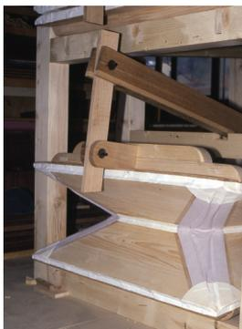
Abb. 4 Geöffneter Keilbalg (deutsche Form mit nur einer Falte, auch *Froschmaulbalg* genannt): Neu-Bamberg (Rheinhausen), Rekonstruktion anlässlich der Restaurierung der Geib-Orgel von 1776 durch Gebr. Oberlinger 1992
