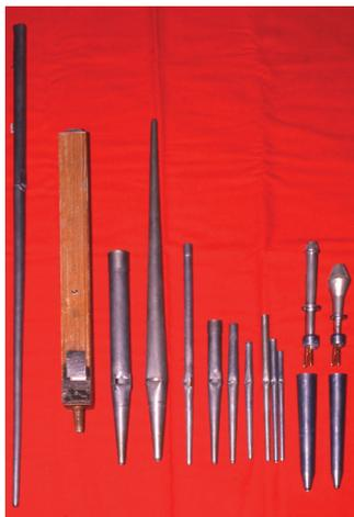
Abb. 20, von links nach rechts (II. Manual): [Prospektpfeife aus Principal 4' fehlt auf dieser Aufnahme] Flöte travers 8' (überblasend mit doppelter Körperlänge), Offenflöte 8' (Holz), Großgedackt 8', Spitzflöte 8', Salicional 4', Stillgedackt 4', Flageolet 2', Quintflöte  $1 \frac{1}{3}'$ , Mixtur 3fach 1', Fagott 8' Bass (hier Pfeife  $h^\circ$ , da ab  $c^1$  Bauartwechsel zum folgenden halben Register), Vox humana 8' Diskant.
