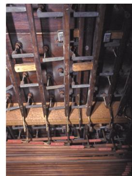
Abb. 14 Spieltraktur im Hauptwerk derselben Orgel wie Abb. 10 mit Kegelhubleisten
