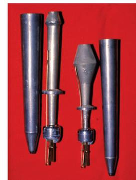
Abb. 21 Fagott 8' h° und Vox humana 8' c¹ aus derselben Orgel wie Abb. 16–17, Zungenpfeifen in französischer Bauform mit Ring und Nuss
