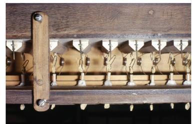
Abb. 9 Geöffneter Ventilkasten derselben Pedal-Schleiflade wie Abb. 5 mit Lederpulpeten
