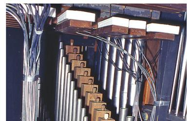
Abb. 18: durch die Orgel verlaufende Bündel von Pneumatikrohren aus Blei
