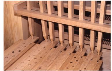
Abb. 15 Mechanische Registertraktur einer seitenspieligen Orgel mit Schwertern, die in die Schleifen eingreifen: Oberlinger-Orgel von 1992 in Altwied (Rheinland-Pfalz) als Rekonstruktion der Johann-Wilhelm-Schöler-Orgel von 1756
