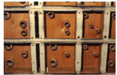
Abb. 17: von diesen Bälgen bediente Rohrstutzen unter der (für das Foto unten geöffneten) Windlade, die nach oben zu den Pfeifenstock-Bohrungen führen
