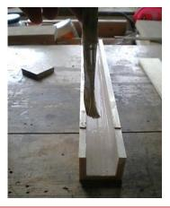
4. An drei Seiten des Kerns Leim angeben **a)** und unten am abgesetzten Pfeifenende eindrücken b), ACHTUNG! Die Unterkanten müssen bündig (gleich) sein! Kurzen Druck auf den Kern geben **b)** und anschließend mit Leimklemme seitwärts andrücken **c)**
